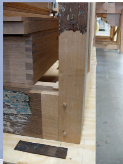
»Bein« der Orgel aus altem und neuem Material
