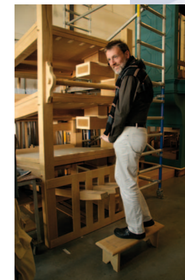
Balganlage mit »Kalkant«
